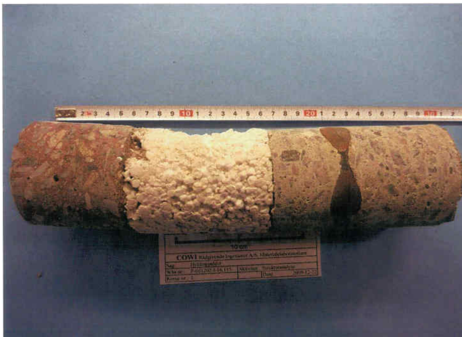
Kerne K1: Facadeelement, prøvehus - Høkerlængen 2. Udboringssiden på kernen (ydersiden) er placeret tv. i foto. Der ses en tredeling med beton yderst og inderst adskilt af et 90 mm tykt polystyren lag.
