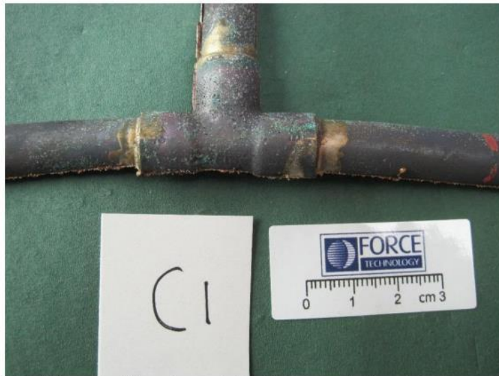
Figur 11 Udvendig overflade på Rørprøve C1 efter afrensning.
