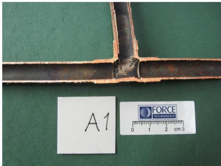
Figur 8 Indvendig overflade på Rørprøve A1 efter afrensning.
