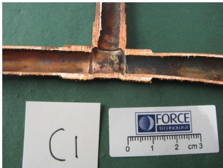
Figur 12 Indvendig overflade på Rørprøve C1 efter afrensning.
